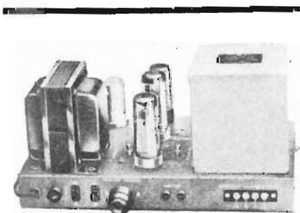
▲ Fig. 12 - Amplificatore di potenza 60-watt, HF-60.
